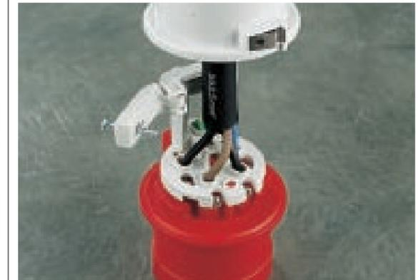
Il fermacavo è posizionato all'interno della custodia in modo da essere protetto contro i danneggiamenti. Il serraggio del cavo viene realizzato con una sola vite utilizzando un cacciavite sia a lama sia a croce. Per facilitare le operazioni di cablaggio il fermacavo è dotato di un "fermo" che lo mantiene nella posizione di aperto evitando l'interferenza con le mani dell'installatore.
