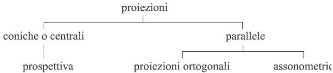
Le assonometrie permettono invece, come le prospettive, di rappresentare la tridimensionalità dell'oggetto, ma sono di più facile realizzazione e permettono, in alcuni casi, di rilevare le quote dell'oggetto dall'assonometria stessa.
